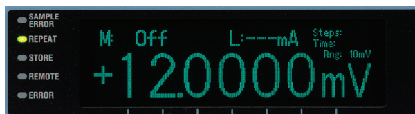
Выход с высоким разрешением с 120000 отсчетами дисплея и минимальными приращениями 100 нВ
